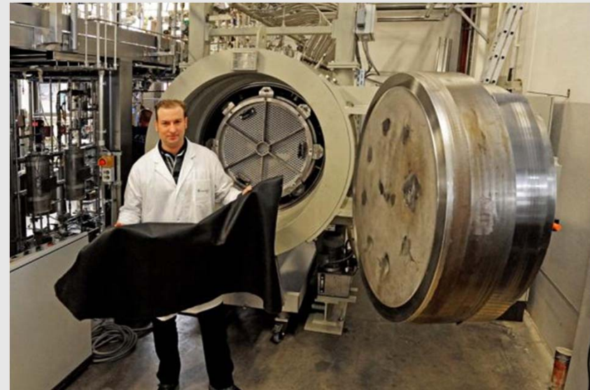
1700 Liter Pilot Anlage bei Fraunhofer UMSICHT
